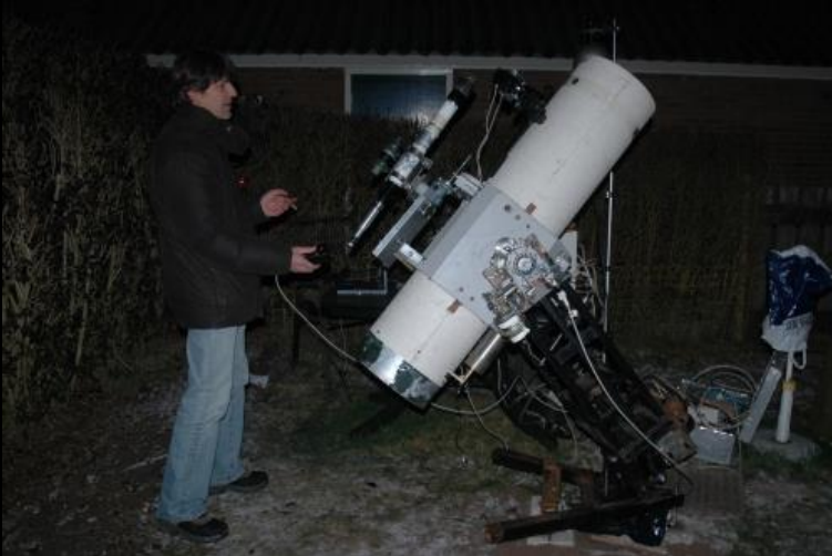
Optische telescoop: 400-700 nanometer
